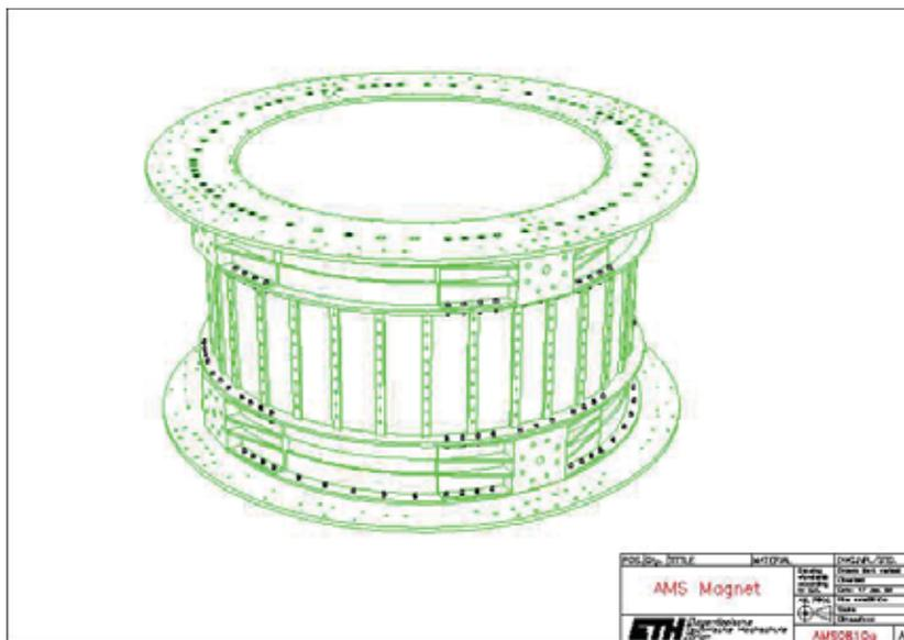
**Figura 3.4:** Il Magnete Permanente di AMS-01 [107].
