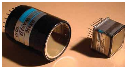
Figura 2.8: Foto di un fotomoltiplicatore R5946 (a sinistra) e di un R5900 (a destra) utilizzato in AMS-01.
