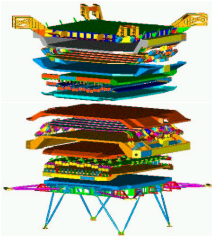
Figura 3.4: Schema complessivo del sistema TOF-02 esploso nelle sue diverse parti [5].
