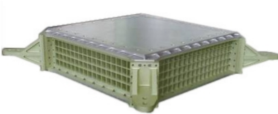
Figura 4.13: ECAL prima dell'installazione dei PMT [22].
