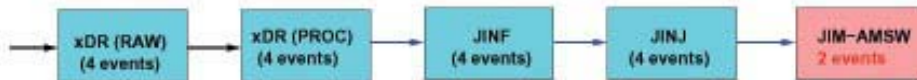
Figura 4.9: Flusso dei dati in AMS-02, per il TOF non è presente il nodo JINF.
