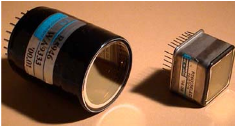
Figura 2.5: Confronto tra un PM del tipo fine mesh utilizzato per il TOF di AMS-02 (a sinistra) ed un PM venetian blind utilizzato in AMS-01 (a destra).
