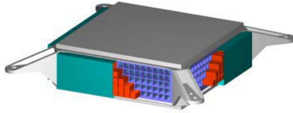
Figura 1.19: Il calorimetro elettromagnetico.
